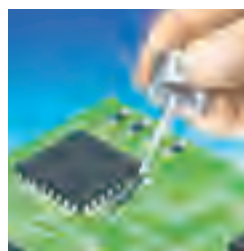
Aufbringen des Flussmittels auf die Pads und Leads des ICs
