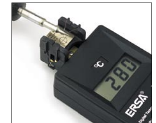
Das DTM 100 besitzt einen Sensorkopf mit Chromel-Alumel-Fühler und ist geeignet für genaue Messungen an sehr feinen Lötspitzen.
